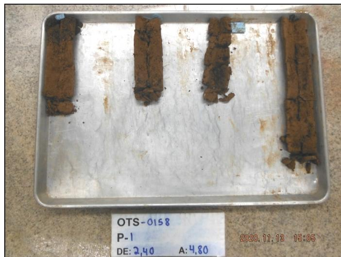
**Fotografías.** Testigos de perforación. De 0,00 m a 4,80 m.
