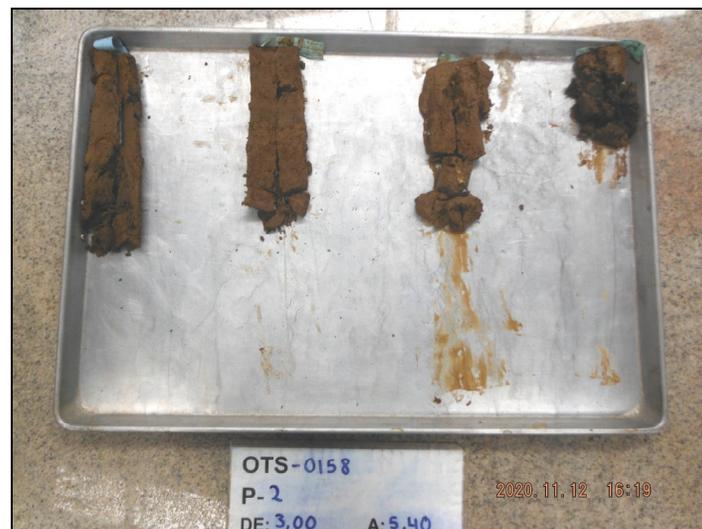
**Fotografías.** Testigos de perforación. De 0,00 m a 5,40 m.
