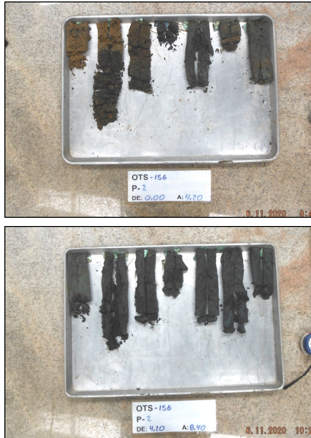
Fotografías. Testigos de perforación. De 0,00 m a 8,40 m.
