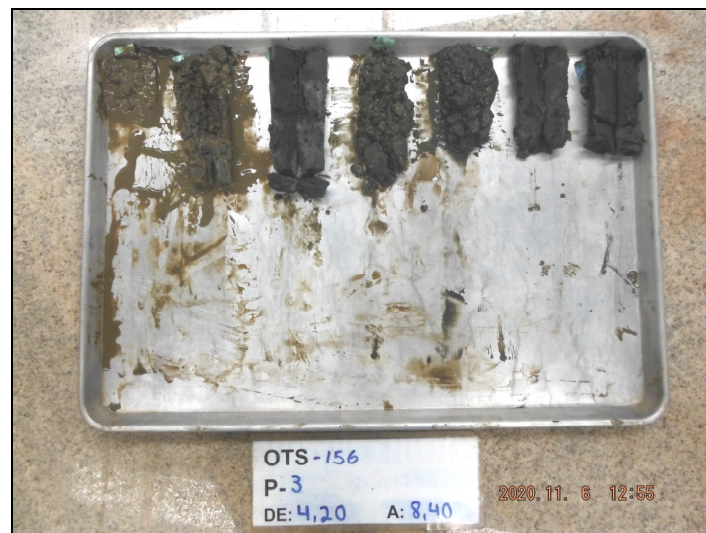
Fotografías. Testigos de perforación. De 0,00 m a 8,40 m.
