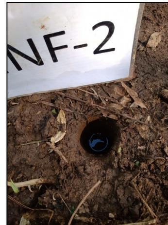
**Fotografías.** Revisiones complementarias mediante sondeos con barrenador manual.
