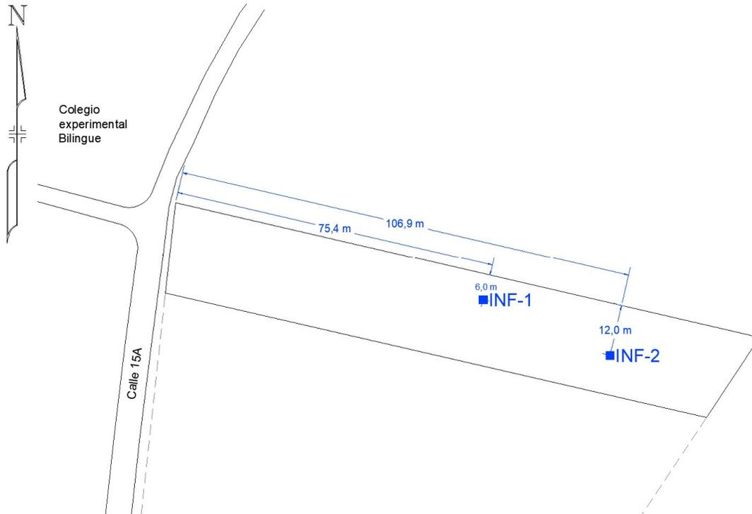
**Figura.** Diagrama de distribución de prueba de infiltración.
